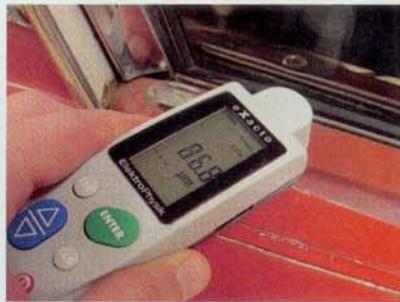
Hilfe für den Restaurator: Schichtdickenmessgerät
