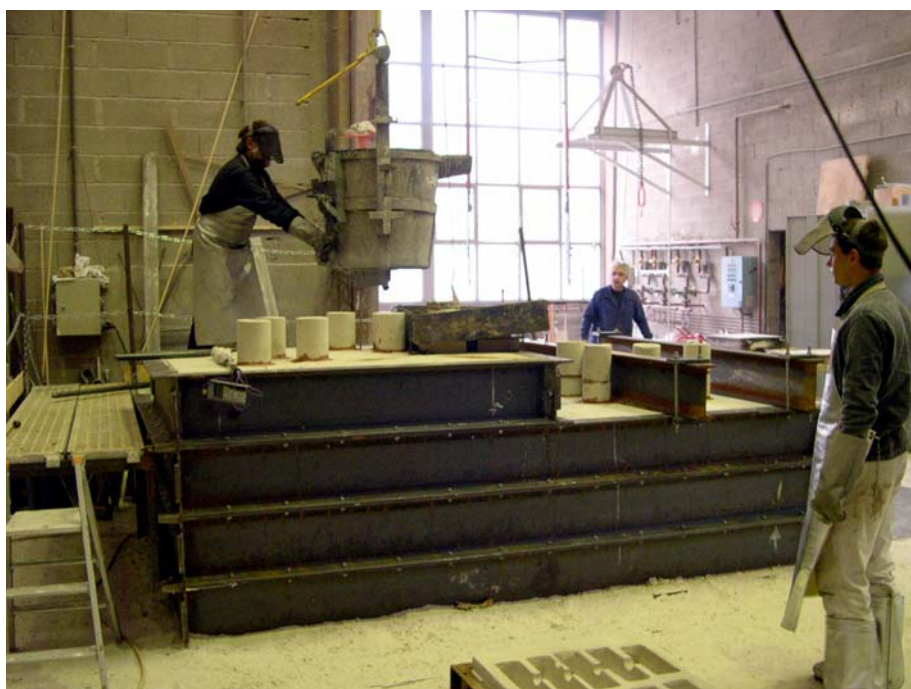
Abb. 34: Fonderie de Coubertin 2004, kurz vor dem Guss des zweiten Teils einer Skulptur von Calatrava. Abgeformt in Kunstharz gebundenem Quarzsand.
