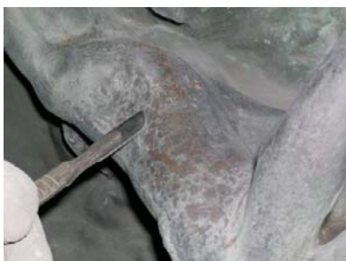
Abb. 55: Freilegung mit Skalpell
