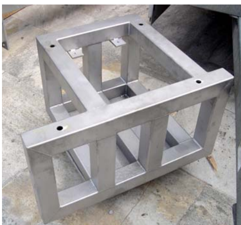
Abb. 69: Linker Korpus nach der Anlieferung. Hier mit der Unterseite gegen oben stehend und den Löchern für die Verankerung im zukünftigen Sockel.
