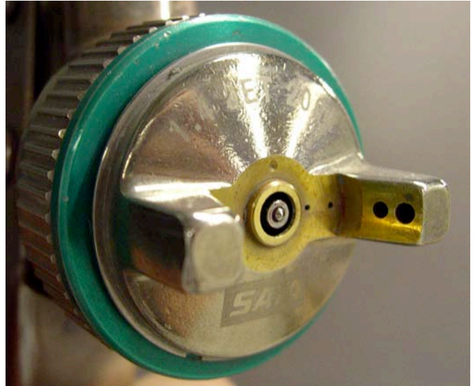
Abb.229: Luftkappe der Fließbecherpistole mit Farbdüse (Mitte), den kleinen Düsen für die Führungsluft und den grösseren Düsen für die Zerstäuberluft, die den Spritzstrahl definiert (Breit- bis Rundstrahl)
