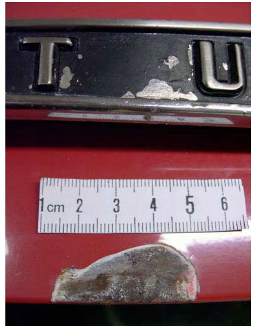
Abb.61: Abplatzung am Kofferraum
