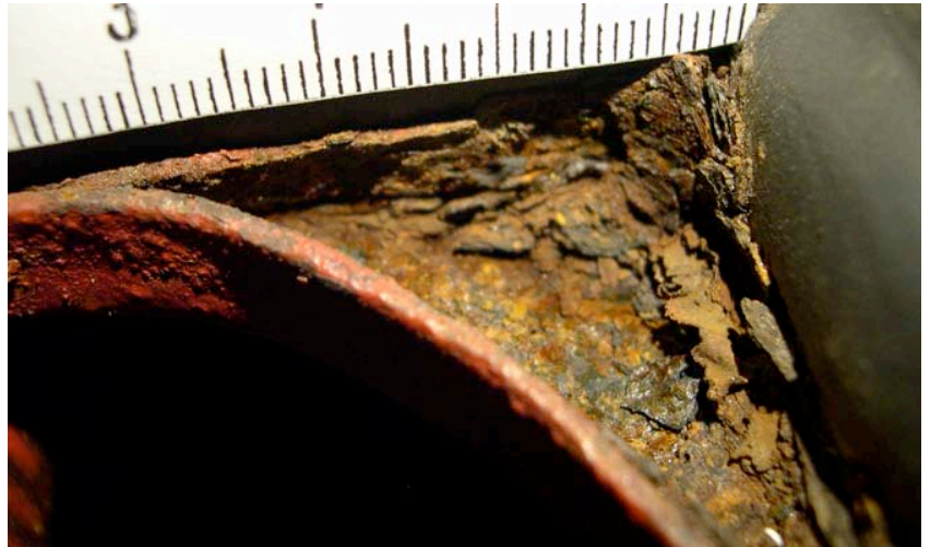
Abb.115: Fortgeschrittene Rostbildung im Kofferraumdeckel
