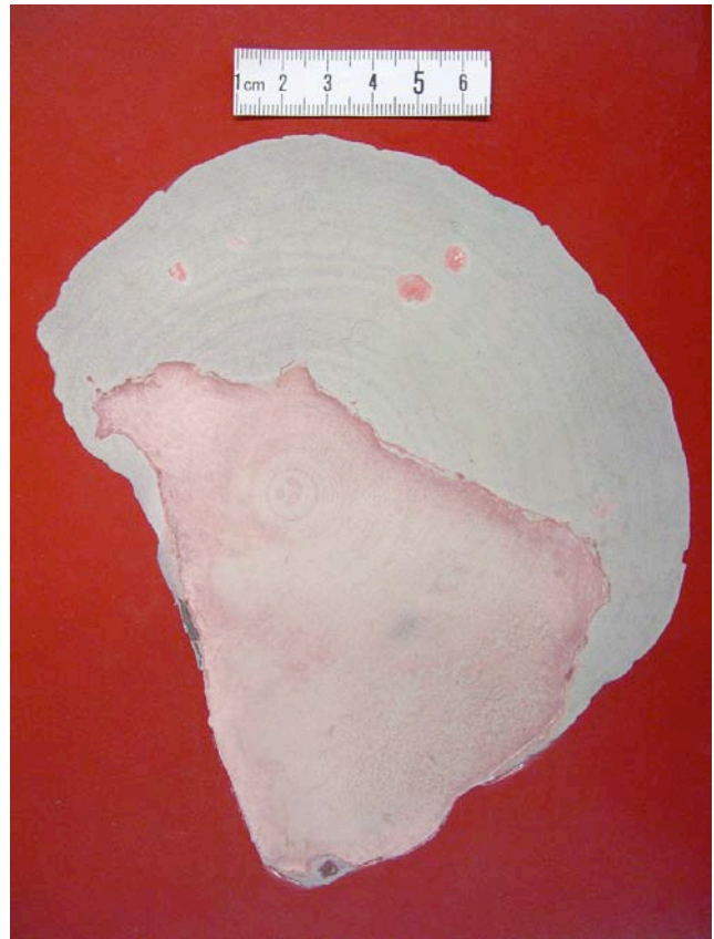
Abb.56: Ablätterung des Lacks als Primärschaden
