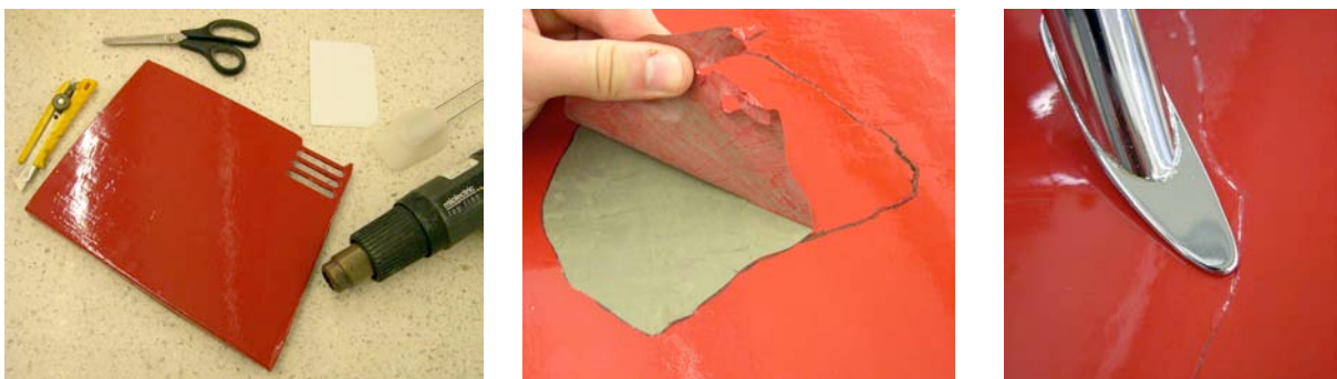
Abb.196 bis 198: Applizierte Folie auf einem Prüfblech, Fehlstelle für die Simulation des Schadens Motorhaube
