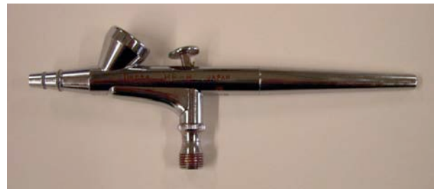
Abb.267: Airbrush mit 0,2 mm Düse
