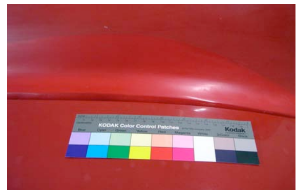
Abb.60: Beilackierung im falschen Farbton
