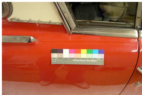
Abb.307: Ersetzte Dichtungsleiste rechte Seite
