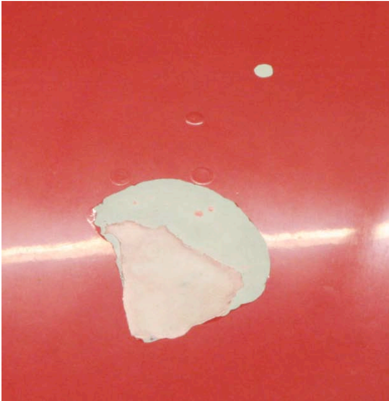
Abb.84: Die Motorhaube mit Abblätterung und weiteren Blasen, eine davon geöffnet für Untersuchungen
