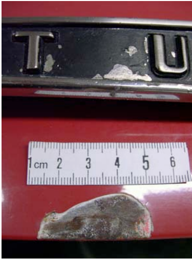
Abb.86: Abplatzung bis aufs Metall
