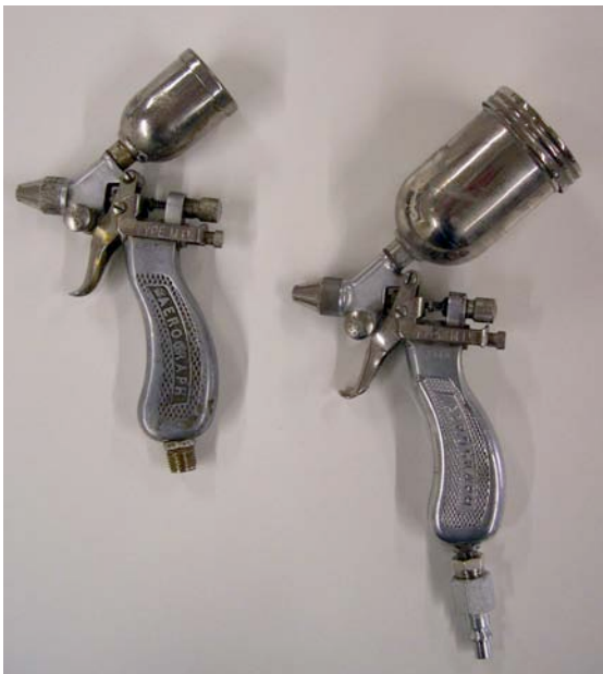
Abb.268: Fliesbecherpistolen mit 1 und 2 mm Düsen
