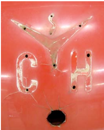
Abb.157: Kofferraum mit demon- tierten Teilen und Messpunkt 0
