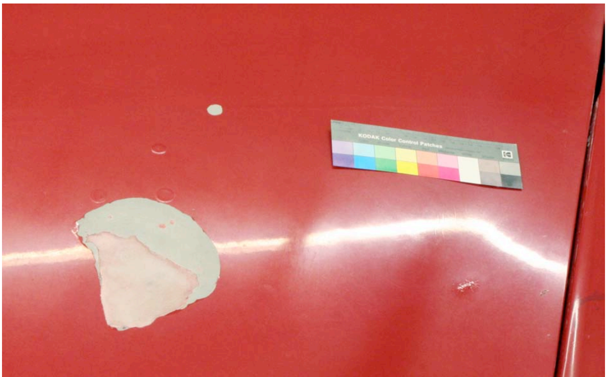
Abb.53: Primärschaden auf der Motorhaube, darüber die Blasenbildung als deren Ursprung
