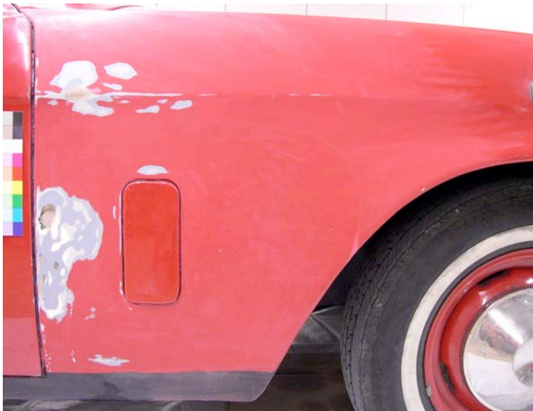
Abb.217: Alte Reparatur und Ausmass der Beilackierung (matt)
