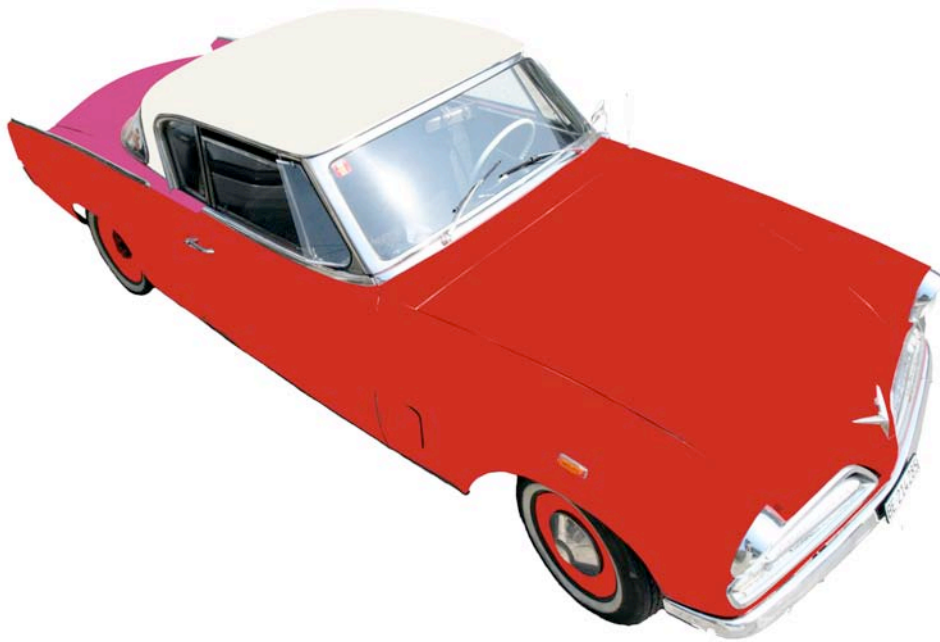
Abb.188: Partielle Reparaturlackierung am Heck (Magenta)
