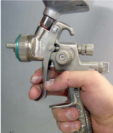
Abb.228: Fließbecherpistole mit Reglern für die Zerstäuberluft (seitlich), der Farbmenge (Rückseite oben), der Druckluftmenge (Rückseite unten) und dem Abzugsbügel
