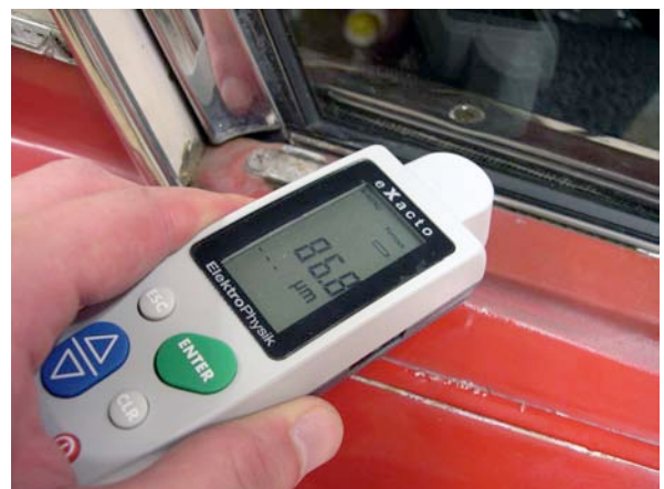
Abb.154: Das Schichtdickenmessgerät bei der Messung des Originallackes
