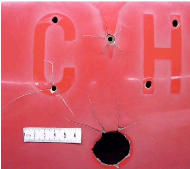
Abb.98: Risse im Lack
