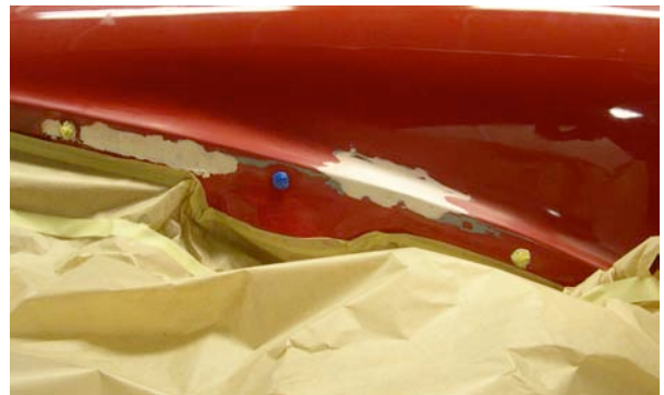
Abb.231: Vorbereitete Spachtelung links
