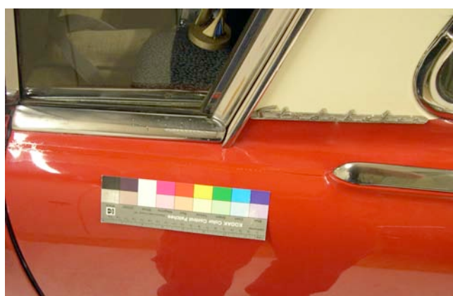
Abb.303: Detail, ersetzte Dichtungsleiste
