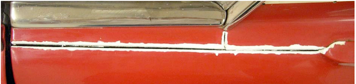
Abb.287: Linke Fuge nach der Grundierung mit 2K-Epoxy-Rostschutzgrundierung
