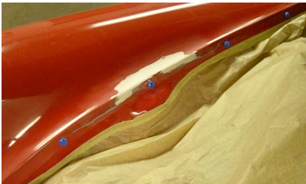
Abb.230: Vorbereitete Spachtelung rechts
