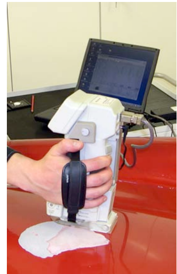
Abb.168: Farbmessung mit Minolta CM 2002
