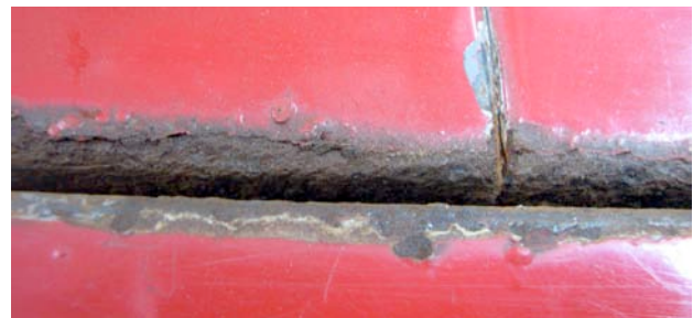
Abb.285: Rostbildung in den Fugen der Karrosierteile
